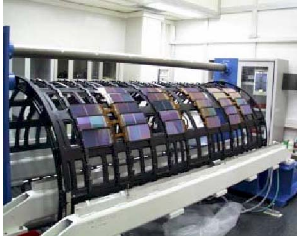
Figura 1.7: Struttura di supporto dei moduli del TIB.
